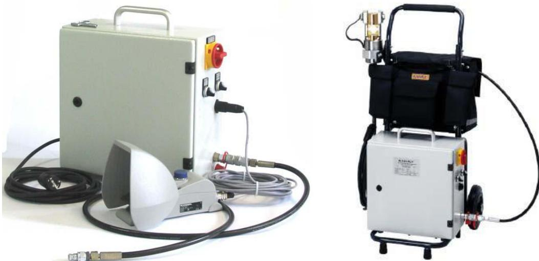
Станция EHP4 стала первой универсальной станцией компании KLAUKE, получившей возможность работать не только совместно с обжимными и отсекающими головами Klauke, но и через гидравлический переходник CMGSK с инструментальным центром для обработки токоведущих шин (BBTC) и с гидравлическими головами Greenlee, используемыми для выдавливания отверстий в
