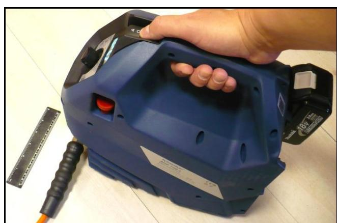
Насосная станция KLAUKE AHP700L рассчитана на применение в качестве привода для совместной работы с гидравлическими головами и стационарными гидравлическими устройствами с рабочим усилием до 100 тон и максимальным рабочим давлением 700 бар. В зависимости от выполняемой операции пользователь может выбирать одну из трех стандартных программ работы станции:
